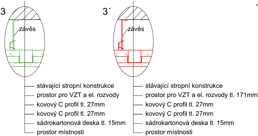
Bourání (3) a návrh (3') podhledů sociálního zařízení
